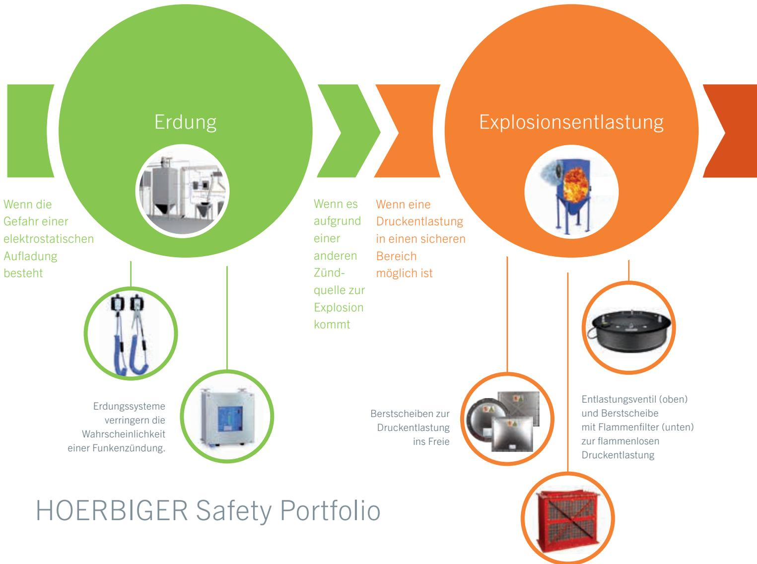
einem Druckanstieg öffnet, bevor der Behälter selbst zerstört wird. Diese Art der Explosionsentlastung ist sehr wirksam – der entstehende Druck und der Feuerball müssen jedoch in einen sicheren Bereich abgeleitet werden. Berstscheiben sind somit eine kostengünstige Option, wenn sich der zu schützende Behälter außerhalb eines Gebäudes oder in der Nähe einer Außenwand befindet, die eine Ableitung nach außen ermöglicht.
